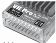
VR Pro Duo另一侧有两路输入电池连接线，可以接两颗电池冗余供电。VR Pro Duo也可以只接一块电池工作。建议采用2组双天20C系列2S锂聚合物电池为VR Pro Duo供电。旁边的3档开关可以选择输出电压，档位分别是5V/6V/7.4V。上述连接确认无误后，将FSS-3上的插针移除即可工作。
